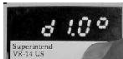
Bild 3.3.6 Inställningsvärdet är för högt, vrid potentiometern en aning motsols
