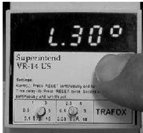
Bild 3.2.4 Inställningsvärdet är över 300 mA. Vrid potentiometern en aning motsols
