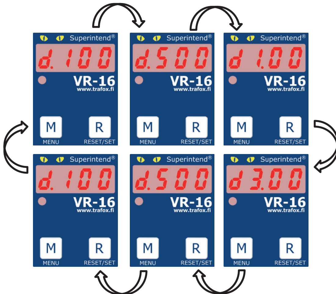
Bild 5 Val av fördröjningstid med korta tryck på M(meny)-knappen. Valet bekräftas med ett långt tryck på R (reset/set)-knappen.
