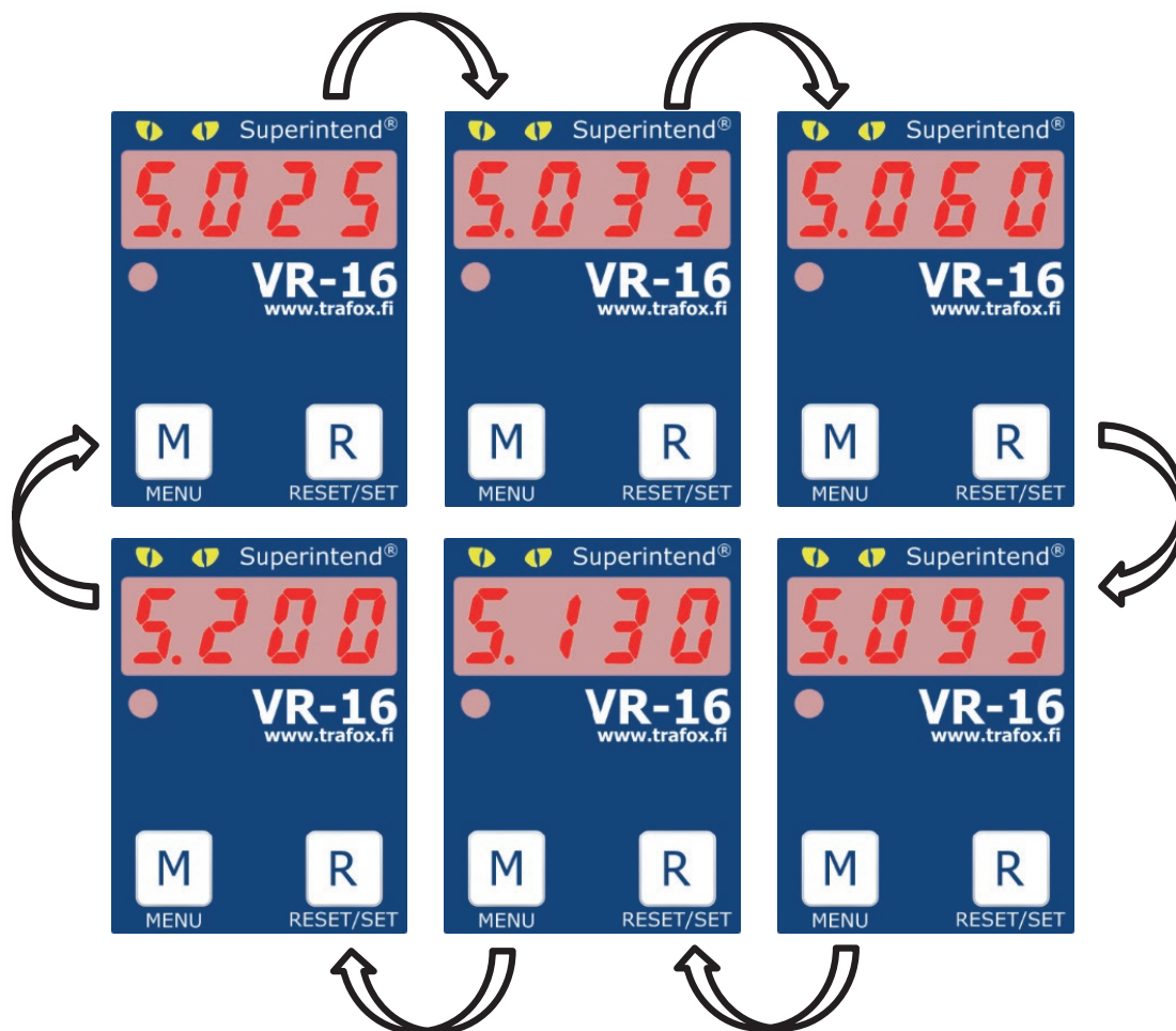
Bild 6 Val av sensor med korta tryck på M(meny)-knappen. Valet bekräftas med ett långt tryck på R (reset/set)-knappen.
