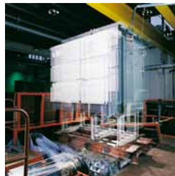
Elektrisk utrustning testas i SP:s skakrigg.
